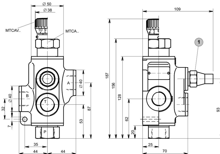
Anschlussgewinde P, A, B und T = M22x1,5 bzw. G1/2"
