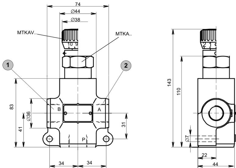
Anschlussgewinde P, A und B = M22x1,5 bzw. G1/2"
