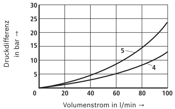
**$q_{V \text{ st}}$ - $q_V$ -Kennlinien bei  $\Delta p$  ( $p_E - p_A$ )**
