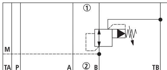
**Druckreduzierung in Kanal P① („P...M“)**
