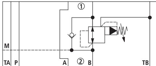
**Druckreduzierung in Kanal A② („A...M“)**
