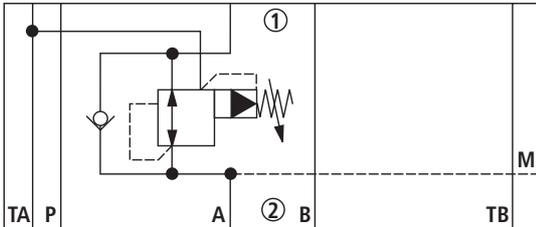
**Druckreduzierung in Kanal B② („B“)**
