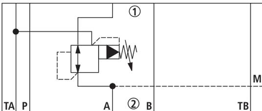
**Druckreduzierung in Kanal B② („B...M“)**
