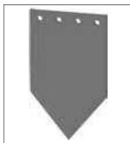
334.001.3: V-förmiges Messer. Standardausrüstung der UPG10 ab Werk. Universelles Messer, verwendbar für die meisten üblichen dünnwandigen Industrieschlauchleitungen mit/ohne Kunststoffspirale. Nicht für Stahleinlagen verwendbar.
