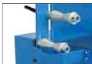
Seitliche Führungsrollen zum einfachen Einspannen und Fixieren des Schlauches, für bessere Schnittqualität. (EM 115)
